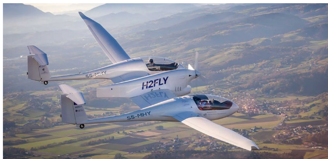
Самолет HY4 с силовой установкой на базе водородно-воздушных топливных элементов
