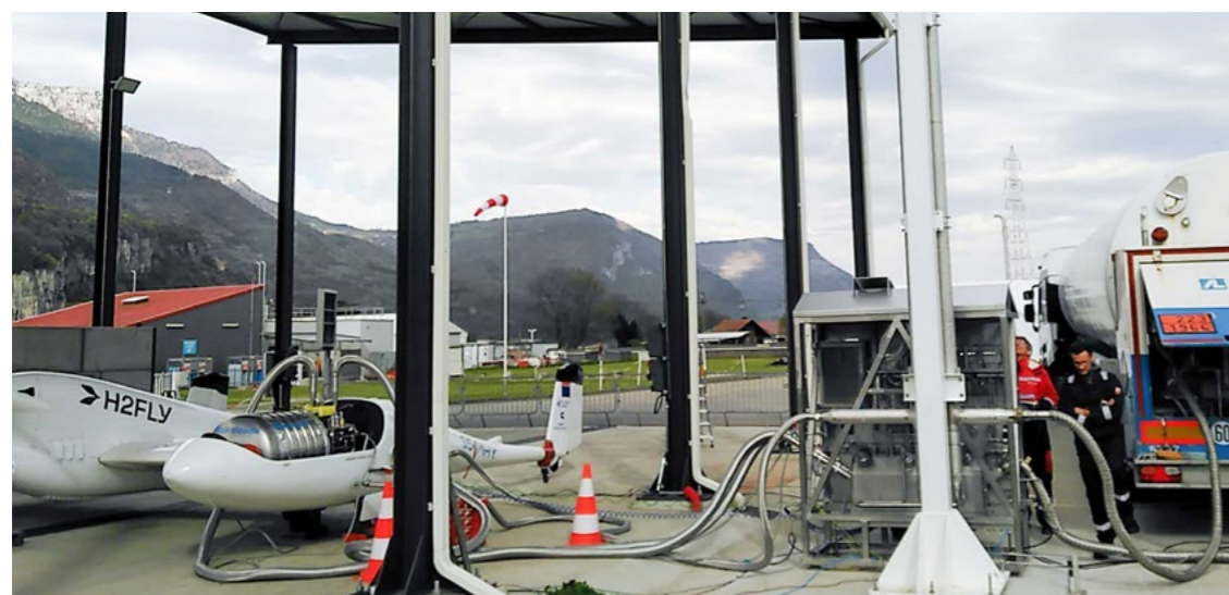
Заправка жидким водородом криогенного топливного бака на самолете-демонстраторе HY4 с силовой установкой на базе водородно-воздушных топливных элементов
