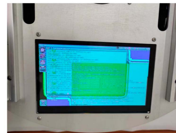
а – нормальное отображение; б – при испытательном напряжении 3 кВ Напряжение в 5 кВ привело к отказу экрана.
