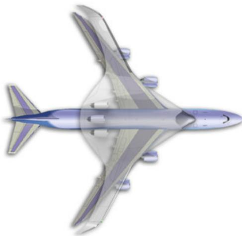
*Сравнение обликов грузового самолета традиционной архитектуры Tube&Wing и архитектуры Blended Wing Body*
