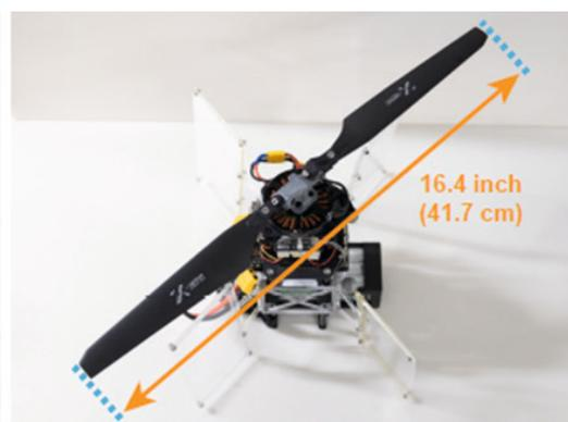
В прошлом выпуске журнала была представлена новость о новом типе БПЛА, который осуществляет свои эволюции в пространстве за счет силовой установки с интегрированным управлением. В настоящем выпуске мы разбираем технические решения, благодаря которым возможна реализация такого БПЛА. БПЛА Pulsar состоит из пространственной рамы, полетного контроллера, одноплатного компьютера, винтомоторной группы с интегрированным управлением, аккумулятора и полезной нагрузки в виде лидара.
