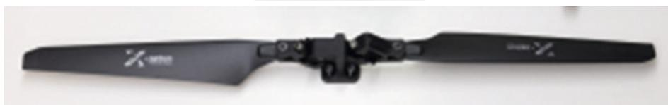
*Электродвигатель с системой управления и воздушный винт с шарниром БПЛА Pulsar*
