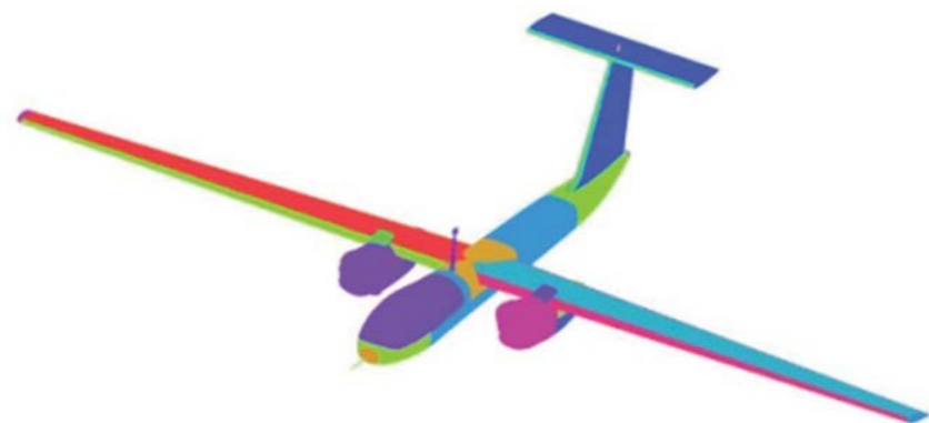
Поверхностная сетка по геометрии БПЛА
