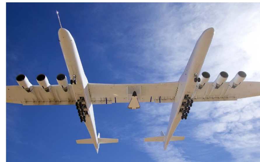
Экспериментальный гиперзвуковой KF Stratolaunch Talon-A на стартовой платформе
