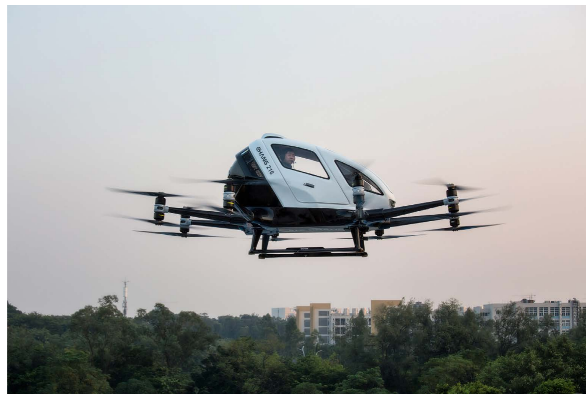
Двухместный автономный eVTOL eHANG EH216 во время испытательного полета
