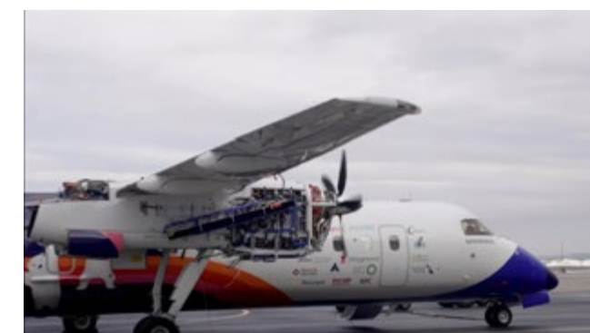
Раскрутка воздушного винта на летающей лаборатории от СУ на базе водородных топливных элементов
