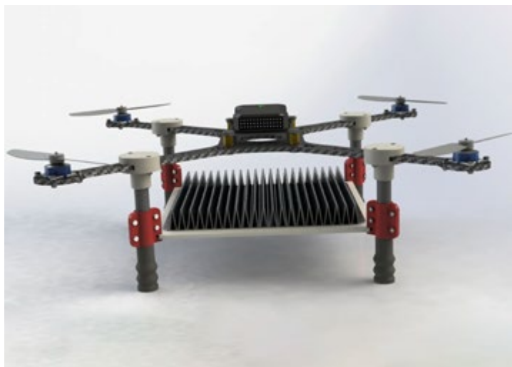
Экспериментальный образец БПЛА с блоком лазерной зарядки
