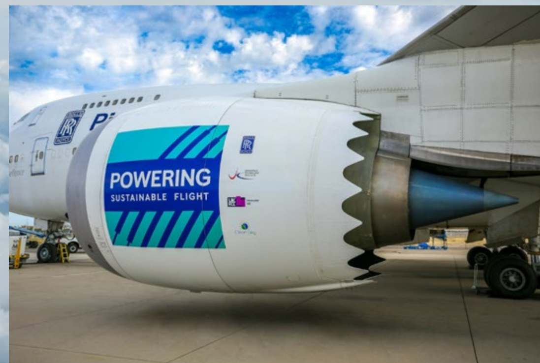
Rolls-Royce Trent 1000 успешно прошел испытания на 100% УПАТ
