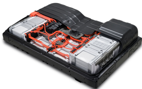
Рис. 2. Батарея типа Li-ion для электромобиля Nissan leaf 62 кВт
